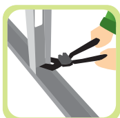
4. ยึดติดระหว่าง C-Stud และ U-Track โดยใช้ริ้วด คีมย้ำโครง หรือสกรูยึ้งโครง ยึดด้านละ 1 จุด
