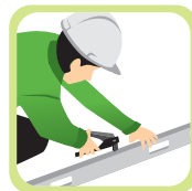
5. บริเวณที่เป็นช่องเปิด ซึ่งจะติดตั้งวงกบ ครอบประอบเหล็ก C-Stud เข้ากับ U-Track หรือ C-Stud เข้ากับ C-Stud ตลอดแนว ความสูงจากพื้นถึงใต้ท้องพื้น
