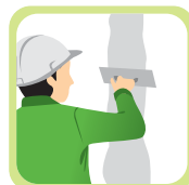
7. อานรอยต่อ และเก็บงาน ทำสีตกแต่งเพื่อความสวยงาม
