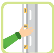
3. วัดความสูงจากพื้นถึงท้องพื้นชั้นถัดไปเพื่อตัดเหล็กตัวตั้ง C-Stud นำเหล็ก C-Stud วางลงในราง U-Track ทุกระยะห่าง 60 ซม.
