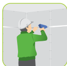
1. ติดตั้งดากริมตัวแอลเข้ากับผนังโดยรอบ ตามระดับฟ้าที่กำหนด
