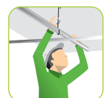
6. ตรวจสอบระดับโกรง SCL แนวนอน อย่างละเอียดอีกครั้งก่อนติดตั้งแผ่นยิปซัม SCL นอก.
