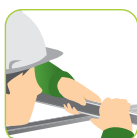
5. ล็อกโกรง SCL แนวนอนเข้ากับโกรงแนวตั้งด้วยกีบล็อค
