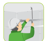
4. ล็อกโกรง SCL แนวตั้งเข้ากับชุดหัวโกรงป.ปลา ปรับระดับโกรงตามต้องการ โดยการปรับสปริงปรับระดับ
