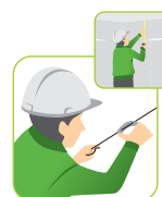
2. ประกอบชุดลวดปรับระดับ โดยใช้สปริงปรับระดับ (Rod Joiner) เชื่อมต่อระหว่างลวด 4 มม. เข้ากับชุดหัวโกรงป.ปลา
